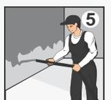
**5** Используя штукатурную станцию, нанесите раствор на стену. Толщину слоя регулируйте уменьшая или увеличивая скорость перемещения штукатурного пистолета вдоль стены. При ручном нанесении «набросайте» штукатурку мастерком или нанесите кельмой слоем от 5 до 40 мм. В случае необходимости применения штукатурных маяков, установите их параллельно друг другу на расстоянии 15-20% от ширины правила.
